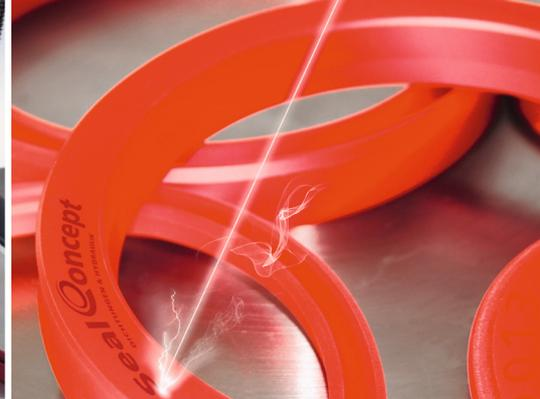
Unser CO<sub>2</sub>-Laser-Beschriftungssystem ermöglicht eine flexible Beschriftung, je nach Kundenwunsch in Form von Texten, fortlaufenden Seriennummern, Codes, Logos und Grafiken. Die Verarbeitung der Vorgaben erfolgt mit Hilfe moderner Grafikprogramme.
